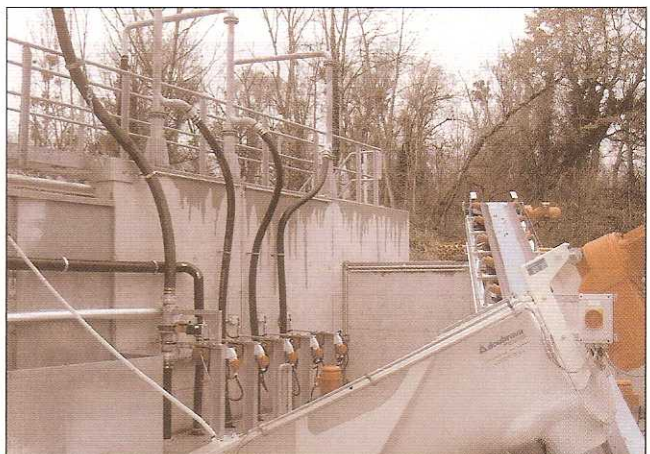
Restbeton-Recyclinganlage von Doubrava für gleichzeitige Rückgewinnung aus zwei Fahrmischern und einer Betonpumpe
